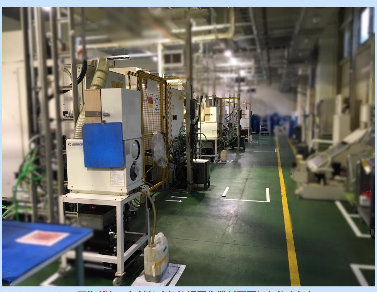
AFTER コンベアやバケットがなくなり切屑作業が不要になりました Conveyor and bucket have disappeared and chip work is no longer necessary
