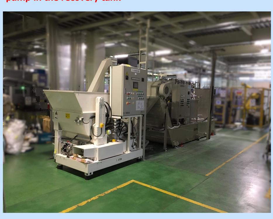
AFTER 精密フィルター装置と切屑圧縮機 Precision filter device and chip briquette machine
